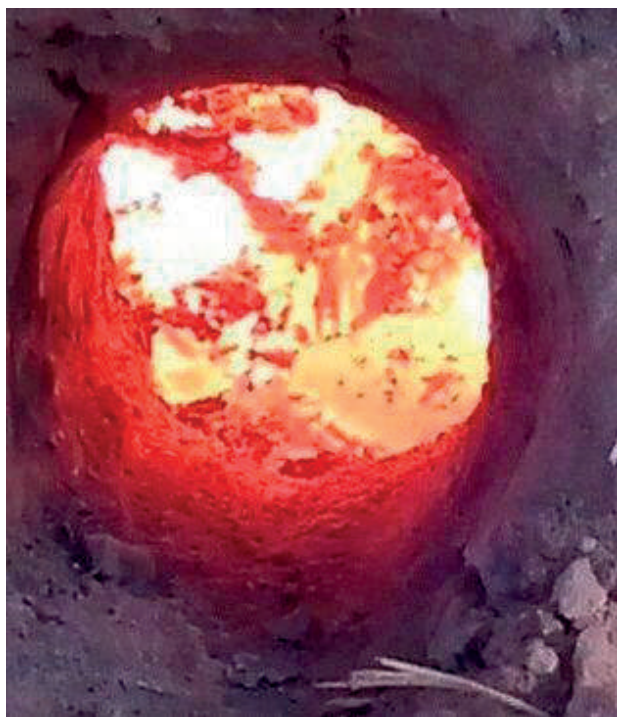
Figura 102. Interior del fondo de un horno experimental en funcionamiento desde el pequeño agujero de 5 cm que tiene en el fondo del crisol.
