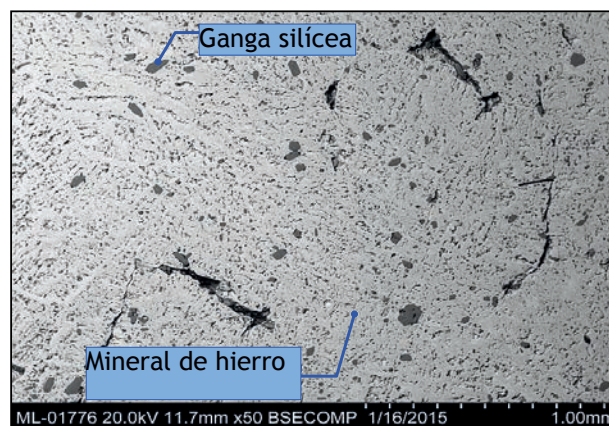
Figura 97. Microestructura de ARR1 UE Corte 3 Min. Vista general representativa (X50), identificando los diferentes elementos. Imagen MEB, electrones retrodispersados.
