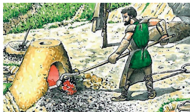
Figura 71. Extracción de la lupia de hierro o "agoa" al final del proceso de reducción en un horno vizcaíno por su parte superior, al que en este caso se ha añadido una hipotética chimenea no constatada arqueológicamente. Dibujo: Fernando Hierro.
