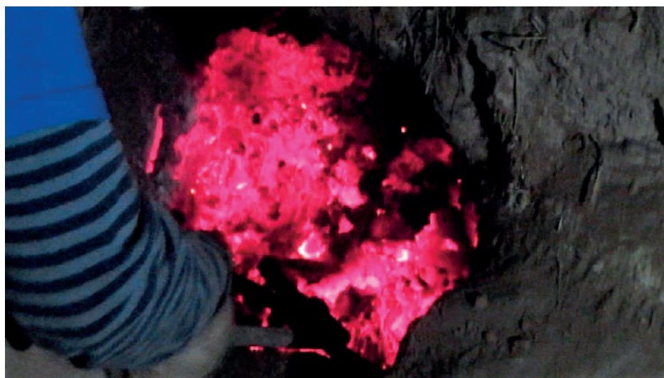
Figura 118. Izda: Sangrado en la experimentación con Jake Keen, colaborador habitual de la University College of London, en Dorset (Reino Unido) 2016. Dcha: experimentación nocturna en el Museo de la Minería del País Vasco, 2014
