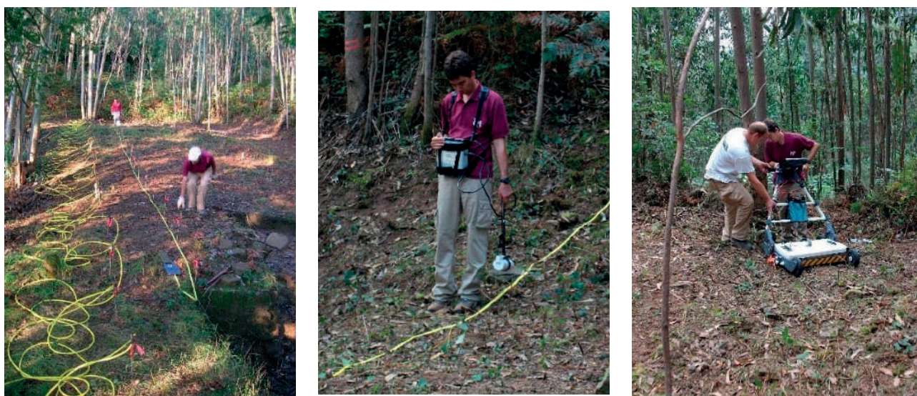
Figura 48. Georadar, tomografía eléctrica y magnetometría en el yacimiento de Callejaverde II (Muskiz).
